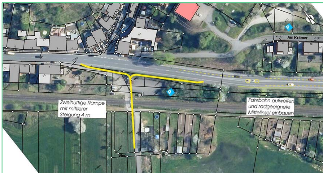
Bild 43: Anschlusssituation der alternativen Radwegeverbindung in Einöd Plangrundlage: Orthofoto Stadt Homburg 2020; eigene Bearbeitung
