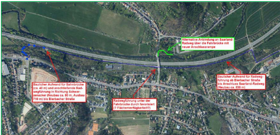
Bild 45: Alternative Radwegeverbindung entlang der Autobahn A8
