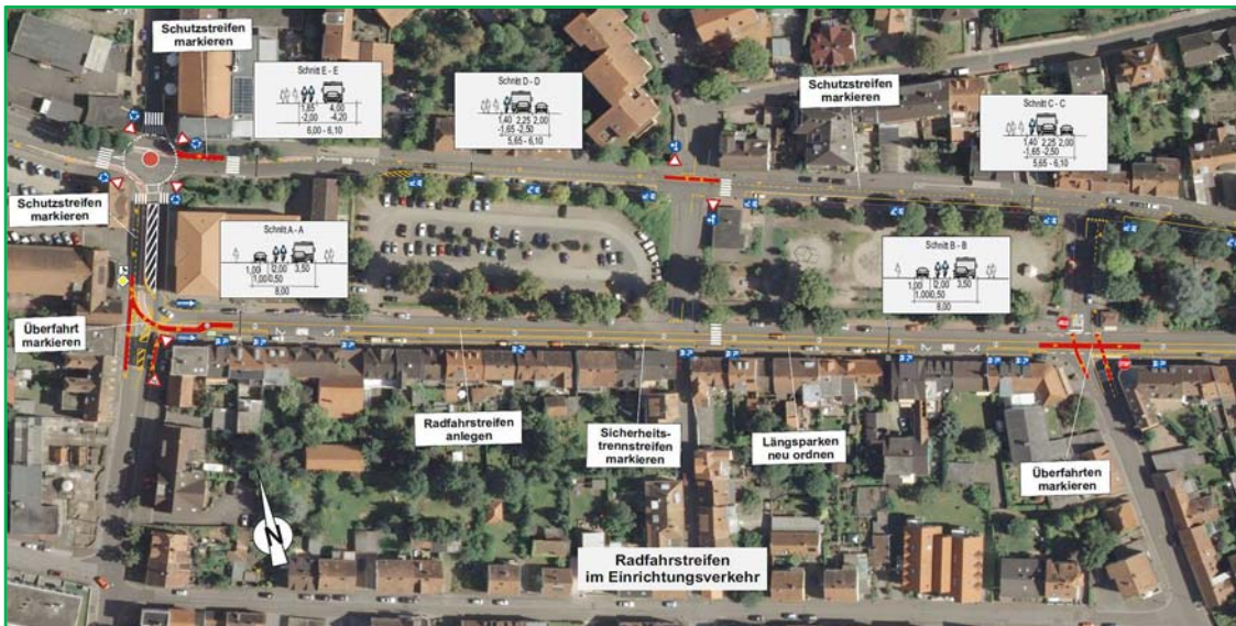
Bild 51: Alternative Führungsformen im Verlauf der Untere / Obere Allee Plangrundlage: Orthofoto Stadt Homburg 2011; eigene Bearbeitung
