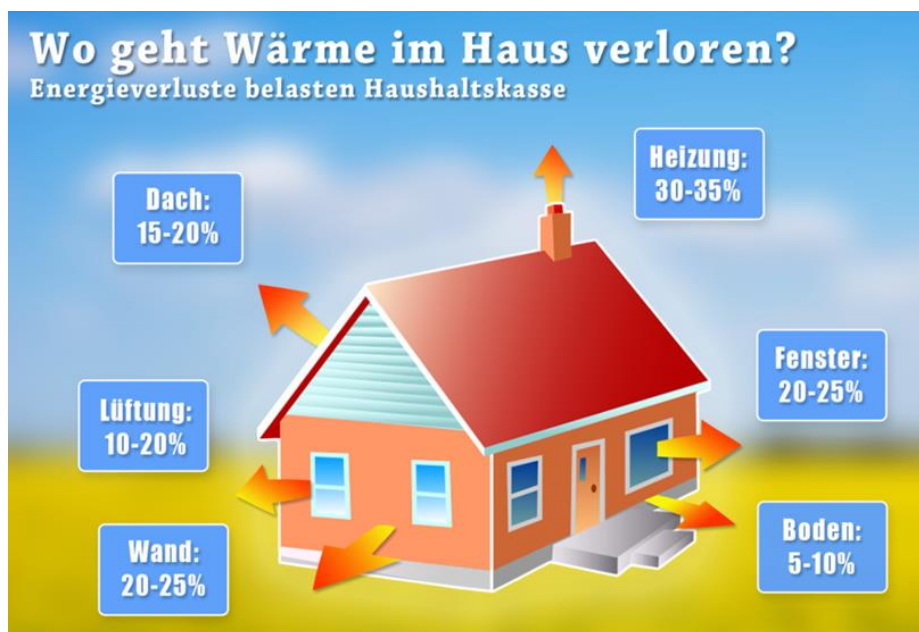
Abbildung 18: Energieverluste bei der Wärmeversorgung bestehender Wohngebäude 21
